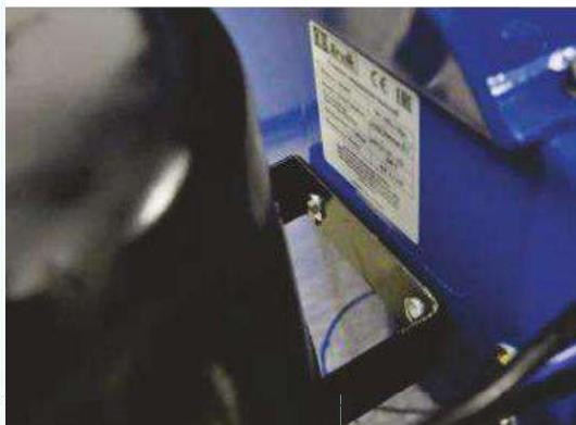
Установите ресивер на крепежные болты так, чтобы шайбы были расположены с обеих сторон кронштейна.
